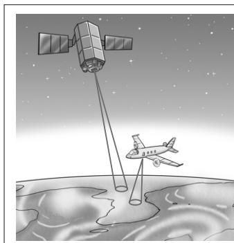
지표 상의 모든 물체는 태양 복사 에너지를 일정 부분 반사하고, 흡수 저장된 에너지를 열의 형태로 방출한다. 위성이나 항공기에 장착된 센서나 카메라는 이 에너지의 양을 측정해 지리 정보를 수집한다. 적외선 카메라는 지표의 운동을 측정하고, 우리나라 아리랑 위성에 탑재된 레이더 센서는 구름을 통과하여 지상에 있는 물체의 고도와 형태를 측정할 수 있다.
